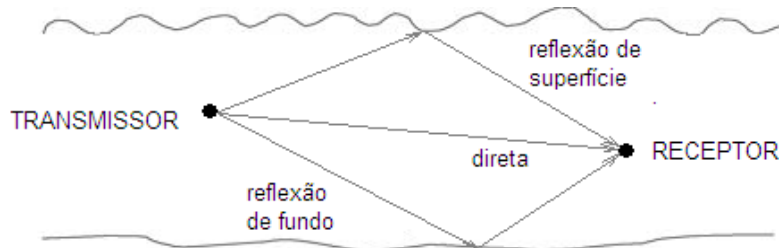
Figura 2.5: Reverberação do sinal acústico na superfície e no fundo do mar.
