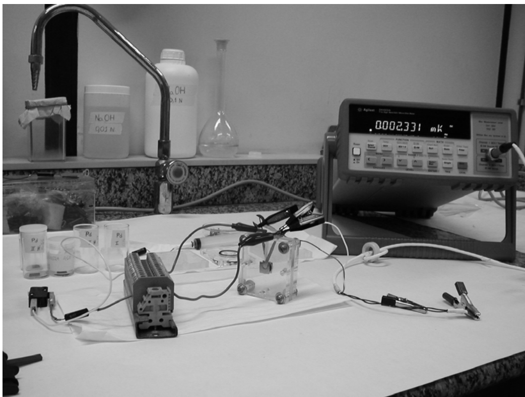
Figura 10: Esquema de medição de tensão na célula.
